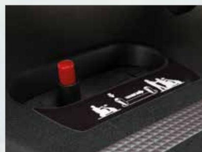
Palanca de desembrague en 2 tiempos que impide que el motor quede desembragado de forma involuntaria
